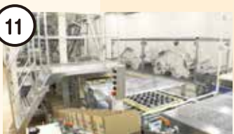
箱詰め ロボットが自動で箱詰めを行います。印字検査ウエイトチェッカーによる検査を行った後、出荷します。
