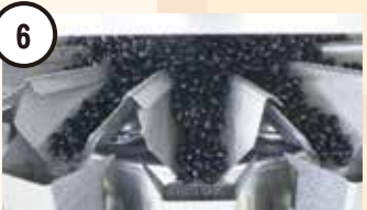
計量 黒豆をすべて自動で一定の重さに計量して、袋詰めをしていきます。
