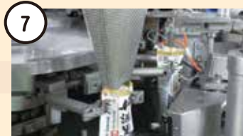
充填 黒豆と調味液を充填し、袋のなかを真空にして包装します。
