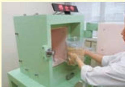
② ゲルマニウム半導体検出器により測定します。
